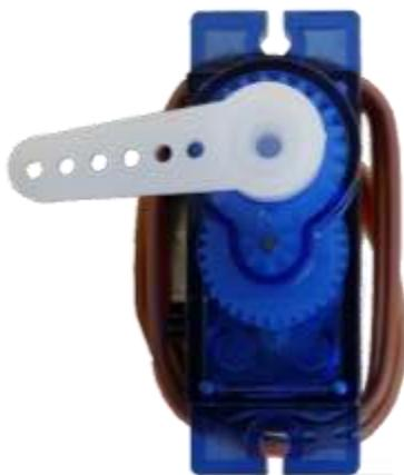
De los acopladores plásticos que contiene el servomotor, coloca alguno de ellos en el eje del dispositivo. Viendo de frente el servomotor como se muestra en la imagen, si giras a la derecha hasta llegar al tope, estarás en la posición 0°; si giras totalmente a la izquierda estará en 180°. Posiciona el eje del dispositivo en 180° observa la imagen. Posteriormente quita el acoplador sin mover el eje.
