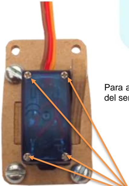
Para asegurar las piezas, los tornillos se insertarán por la parte trasera del servomotor como se observa en la siguiente imagen.
