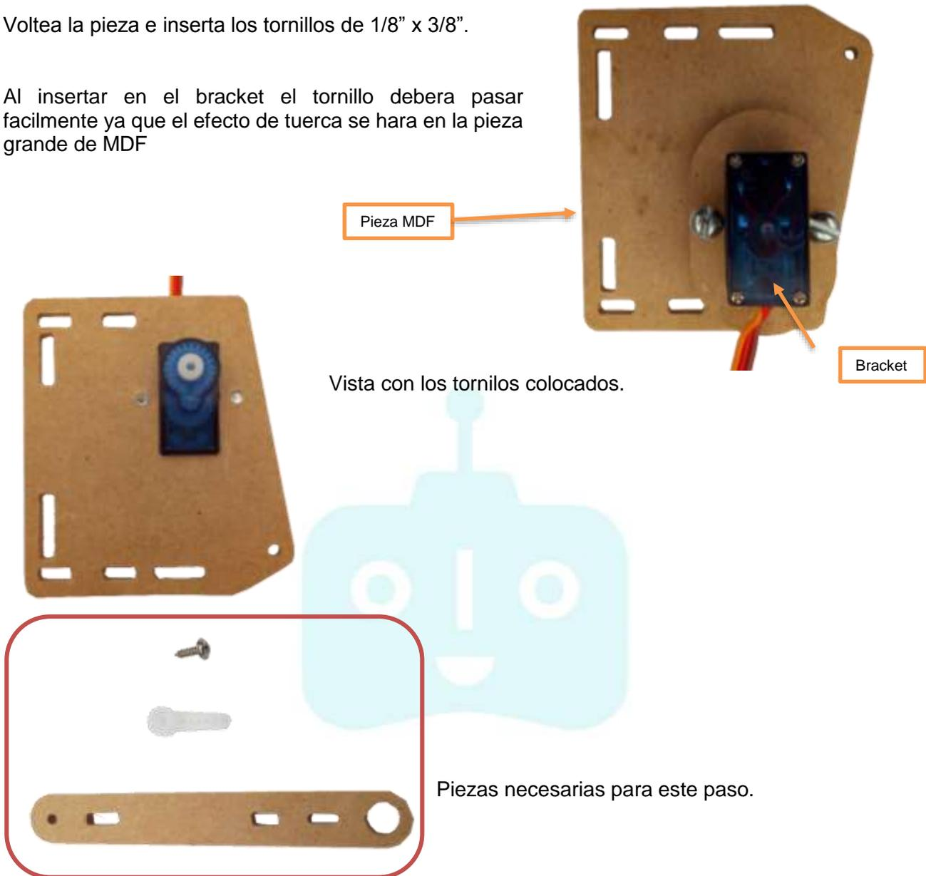
Coloca el acoplador del servomotor hacia la pieza MDF como se observa.
