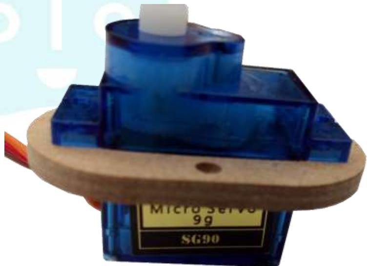
1.2 Colocación del Servomotor en la Base de MDF.
