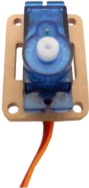
Coloca el servomotor como se observa en la imagen. Toma en cuenta que el bracket MDF tiene un espacio para que pase el cable.
