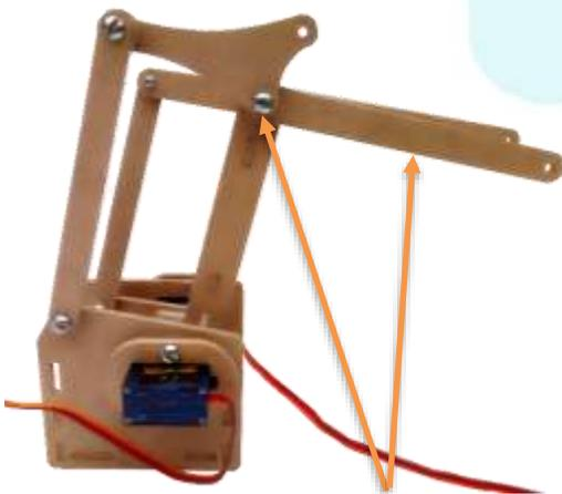
Atornilla la pieza de tres orificios con la barra hasta quedar firme pero con movimiento.
