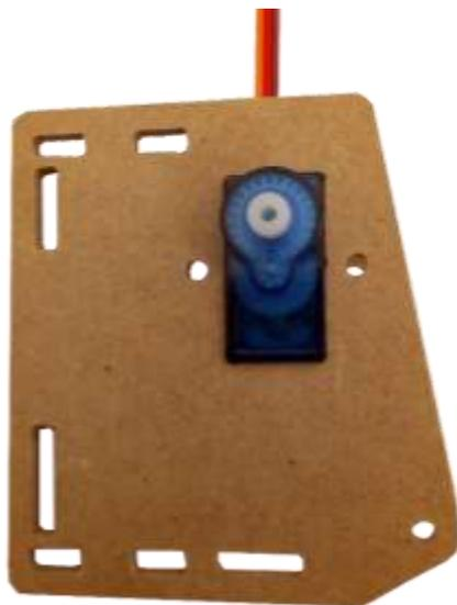
El servomotor debe quedar de la siguiente forma.
