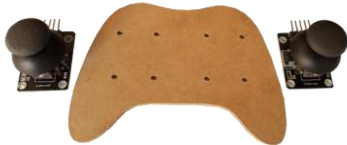
Enrosca los 2 joystick con los tornillos de 1/8 x 3/8 como se observa en la imagen.
