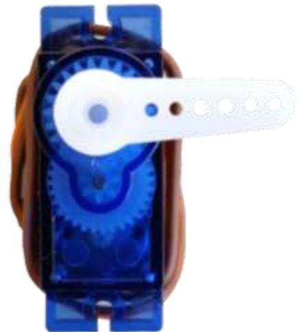
Nota. No necesariamente los extremos estarán exactamente en línea recta horizontal como lo muestra la imagen, esto dependerá de la posición inicial en la que esté el eje del servomotor.
